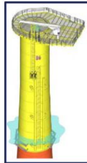
Figure 2: Schéma d'une pièce de transition
